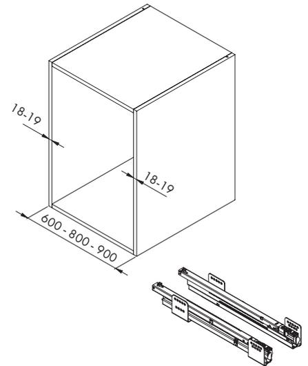
2. Сделайте разметку корпуса согласно заданным размерам, установите направляющие (В) и зафиксируйте их винтами.
