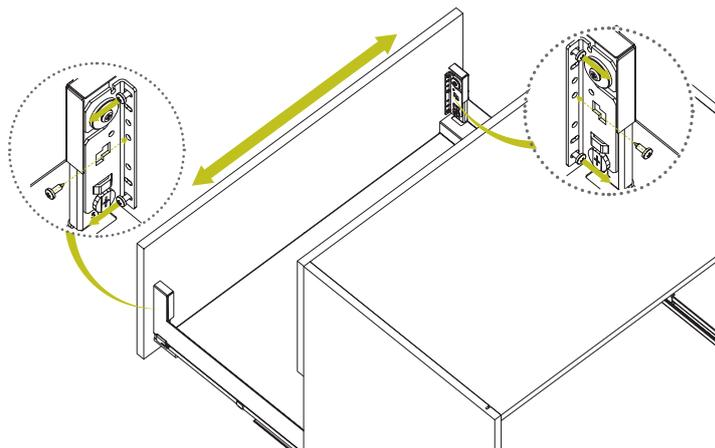
8. Зафиксируйте нижнюю часть корпуса к фасаду с помощью винтов 3,9x13.
